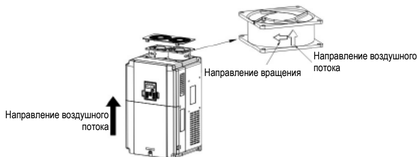
Монтаж вентилятора в инверторах: 3 фазы / 380 В, мощностью более 4 кВт
