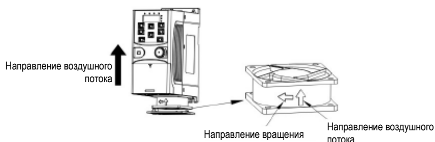
Монтаж вентилятора в инверторах: 1 фаза / 220 В, мощностью менее 2,2 кВт
