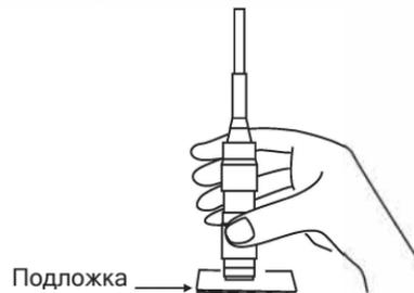
с. Не поднимайте наконечник датчика и нажимайте клавиши “▲” и “▼” чтобы исправить показания, после того как калибровка завершена, прибор готов к обработке. В это время на ЖК-дисплее отображается следующее изображение:
