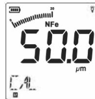
Нажмите “▲” и “▼” чтобы настроить отображаемое значение равным толщине стандартного элемента, а затем поместить следующий стандартный элемент на основание для калибровки.
