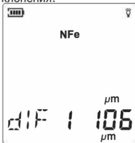
○ Поместите щуп на целевую деталь, которую вы хотите измерить, затем слегка нажмите на него, чтобы измерить, прозвучит зуммер, на ЖК-дисплее отобразится значение. Разница между последним показанием и текущим показанием на ЖК-дисплее отображается, как показано ниже:
