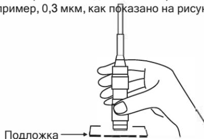
б. Не поднимайте наконечник датчика и нажмите звуковой сигнал указывает, что калибровка нулевой точки завершена. В это время на ЖК-дисплее отображается следующее изображение:
