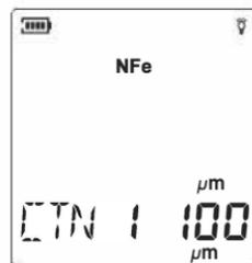
Поместите щуп на целевой объект, который вы хотите измерить, а затем слегка нажмите на него, чтобы измерить, зуммер не будет звучать во время измерения, на ЖК-дисплее будет непрерывно отображаться результат измерения, последнее значение измерения будет сохранено в тесте автоматически. На ЖК-дисплее одновременно отображается CTN 1.
