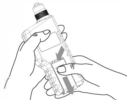
2). Вставьте батарею 9 В в батарейный отсек, обратите внимание на полярность батареи, а затем закройте крышку батарейного отсека, как показано на следующем рисунке:
