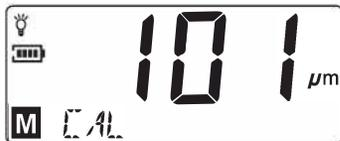
Нажимайте клавиши «вверх» и «вниз», чтобы отрегулировать отображаемое значение до тех пор, пока показание не станет равным толщине стандартного элемента, а затем поместите следующий стандартный элемент на подложку для калибровки.
