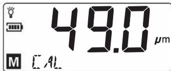
Нажмите клавиши ВВЕРХ и ВНИЗ, чтобы отрегулировать отображаемое значение до тех пор, пока показание не станет равным толщине стандартного элемента, а затем поместите следующий стандартный элемент на подложку для калибровки.
