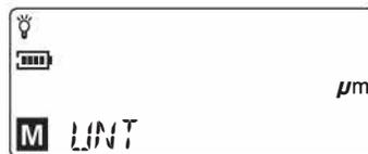
○ Нажмите клавишу ZERO / ON, вы можете выбрать желаемую единицу на μm или mil, на ЖК-дисплее отображается следующее изображение:
