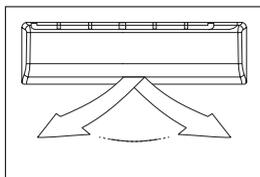
Акуратно поверніть основну пластину жалюзі при вимкненому кондиціонері вниз, щоб побачити вертикальні напрямляючі (жалюзі), що виконані з прозорої пластмаси.
