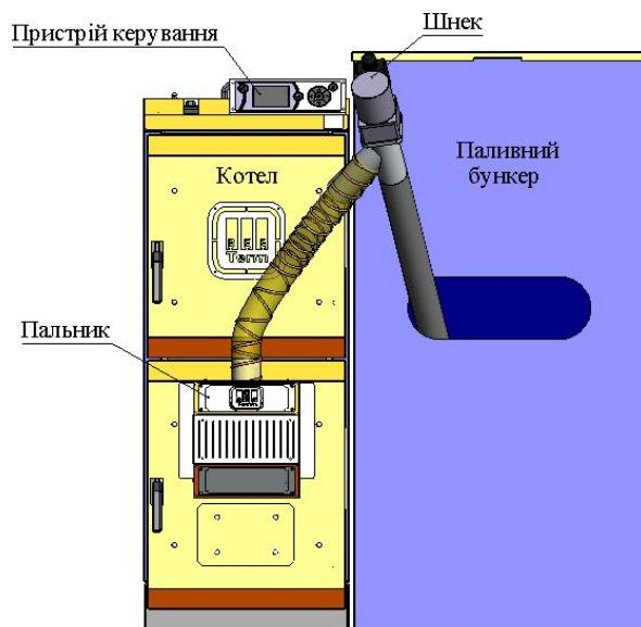
Мал. 8 – Схема установки пальника і пристрою подачі
