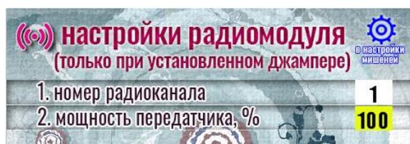
Настройка радиомодуля производится в случае, если необходимо произвести изменение частоты радиообмена или изменение мощности передатчика. Номер радиоканала и мощность передатчика
