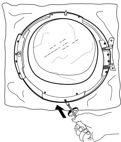
**18.** Вставьте дверной замок в отверстие на правой стороне. Надавите на замок так, чтобы он полностью вошел в отверстие, а затем сместите его немного вниз — до защелкивания штырька.
