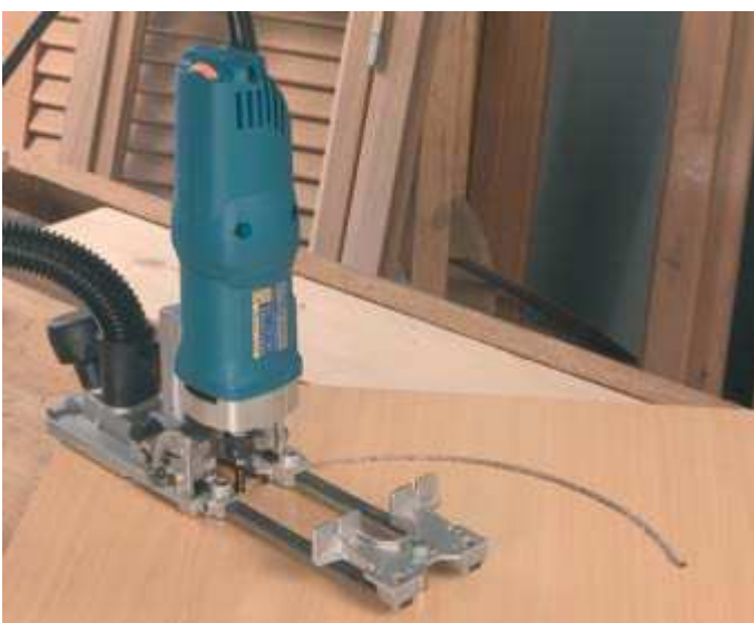
Фрезерование окружности при помощи циркульного приспособления.
