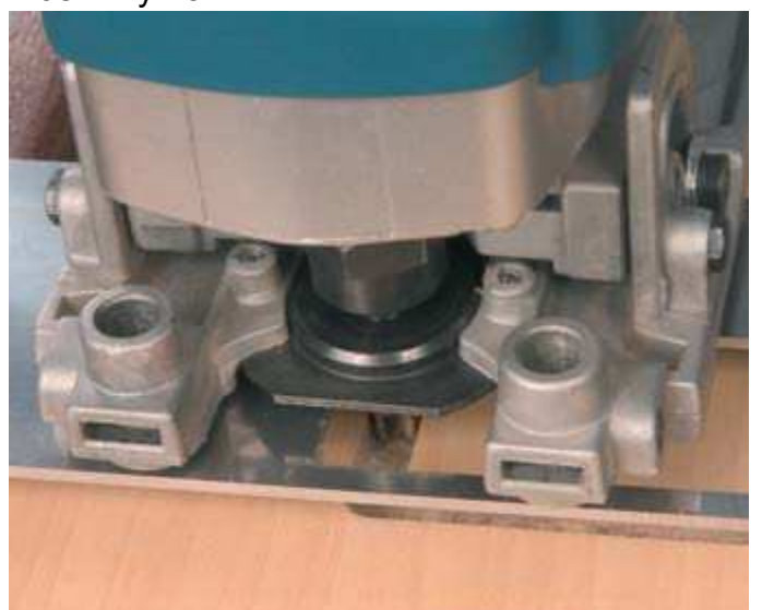
С помощью бокового упора можно делать прямые продольные пазы на пласти под любым углом.
