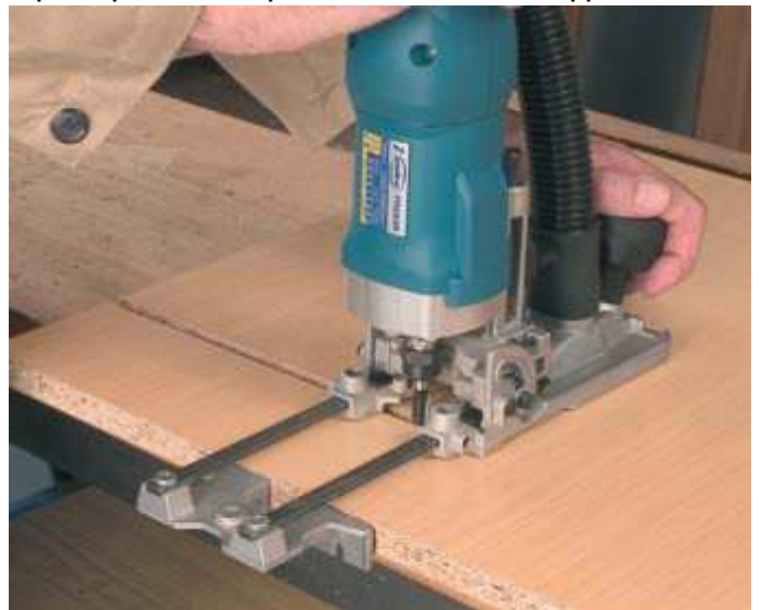
С помощью бокового упора можно делать прямые продольные пазы на пласти под любым углом.
