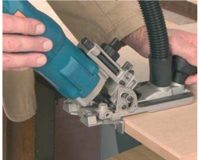
Фрезерование фаски конической фрезой.
