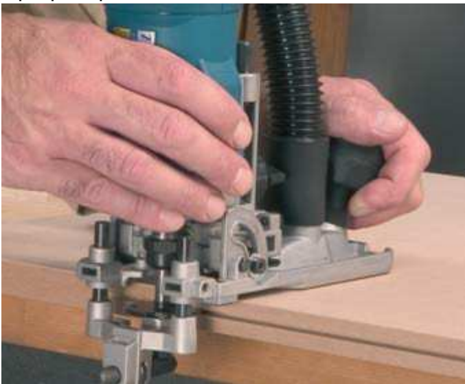
Фрезерование пазов под Т-образный врезной кант.
