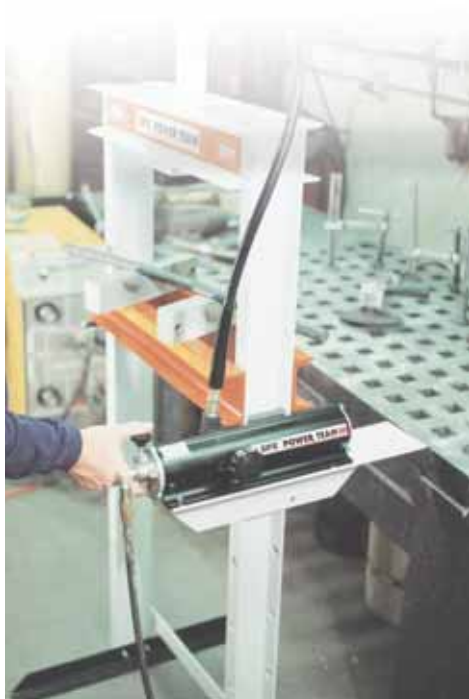
Насос РА9Н с ручным управлением, используемый в качестве привода для выпрямляющего пресса.
