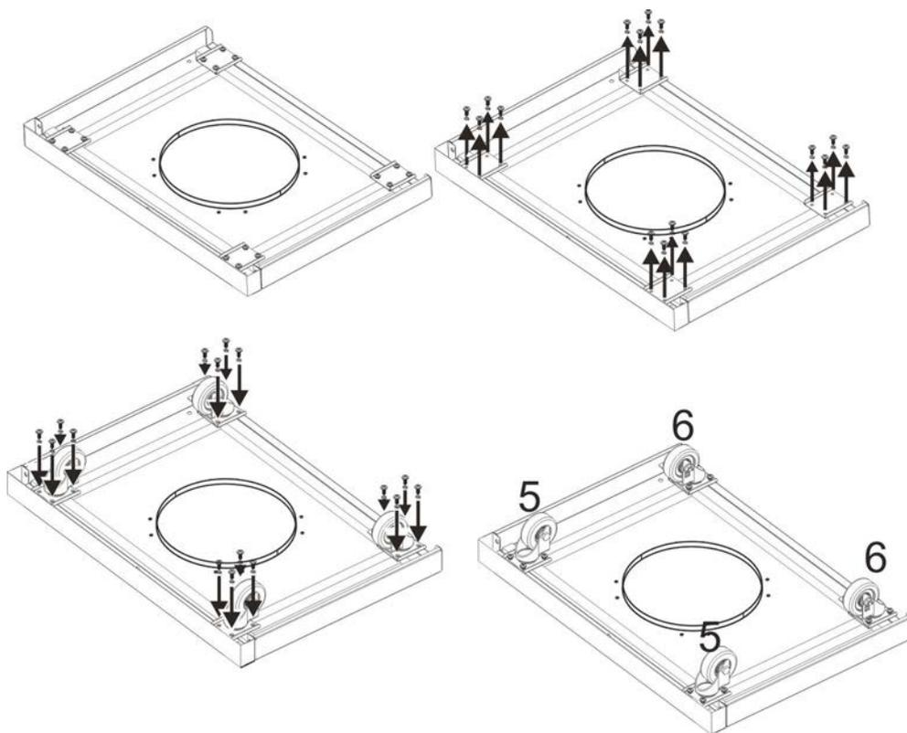
Открутите сначала болты, установите ролики в правильное положение, а затем зафиксируйте их болтами.
