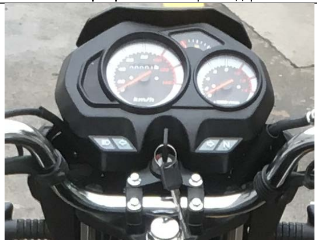
Велика комбінована панель приладів: спідометр/одометр, тахометр, покажчик рівня палива, дальнє світло, повороти, нейтраль, номер включеної передачі.
