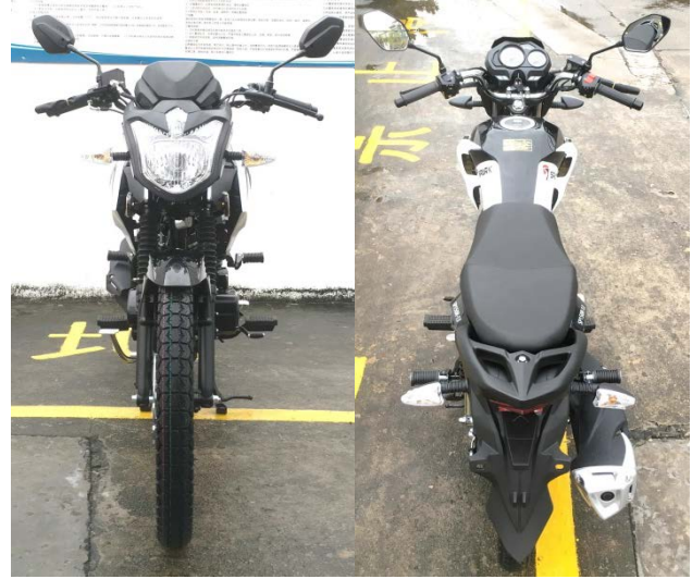
Фара з гладким склом і сегментованим відбивачем, дальнє/ближнє світло, підсвічування. Передні і задні покажчики поворотів на гнучких кріпленнях. Вся оптика сертифікована за євростандартом.
