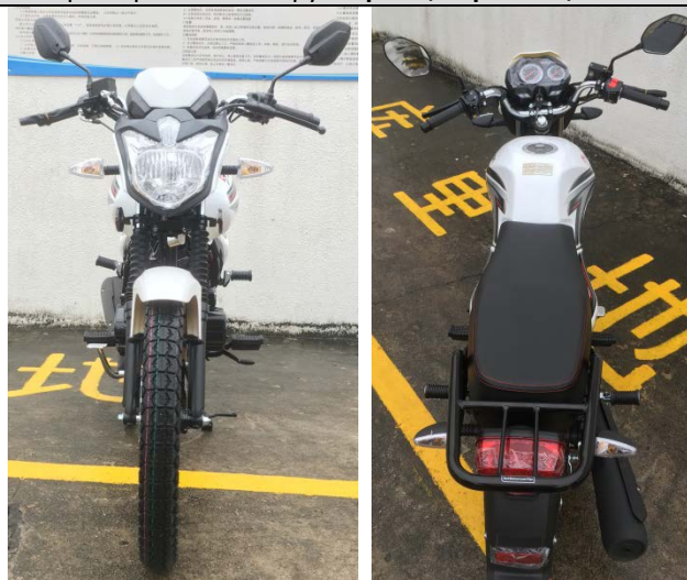
Фара з гладким склом і сегментованим відбивачем, дальнє/ближнє світло, підсвічування. Передні і задні покажчики поворотів на гнучких кріпленнях. Вся оптика сертифікована за євростандартом.
