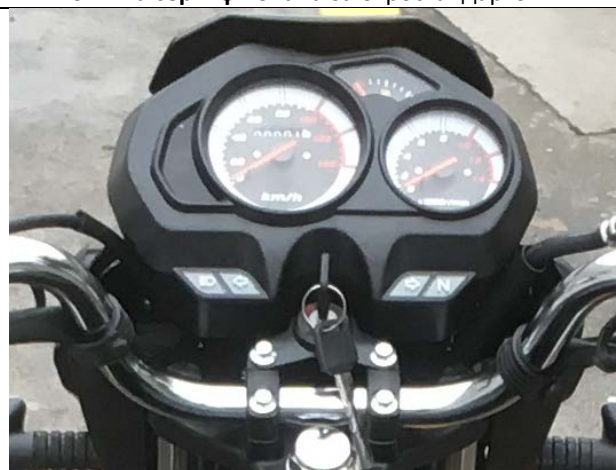
Велика комбінована панель приладів: спідометр/одометр, тахометр , покажчик рівня палива , дальнє світло, повороти, нейтраль, номер включеної передачі.
