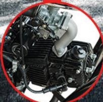
Сорочка циліндра з поздовжніми ребрами охолодження. Карбюратор Jарап PZ19, заводські мітки регулювання
