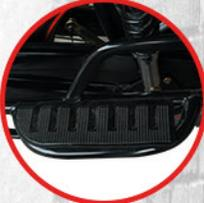
Задня підніжка платформного типу з антифрикційною накладкою, амортизатори з захисним стаканом, захист ніг пасажирів
