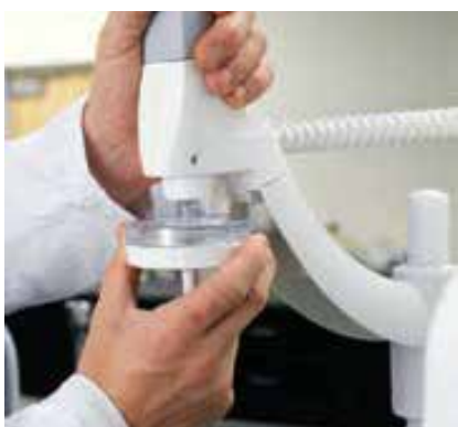
Замена финишного фильтра Millipak® Express 40
