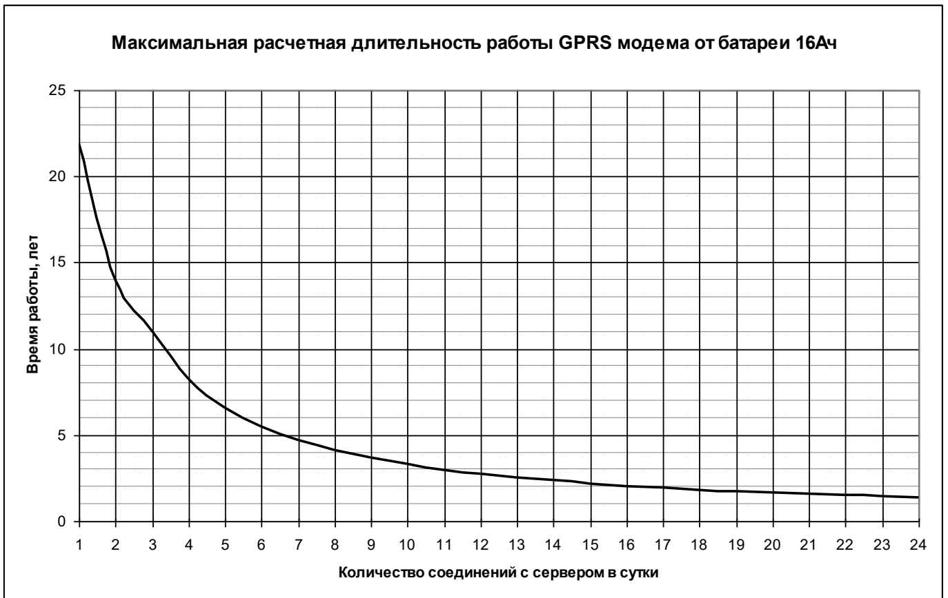
Рис. 4. Зависимость продолжительности работы батареи GPRS-модема от количества соединений с сервером в сутки.
