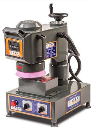
Настольный плоскошлифовальный станок VDG2015. Для шлифовки мелкогабаритных деталей по типу регулировочных шайб с точностью до 0,01 мм. Станок оборудован цифровой индикацией. Детали крепятся на магнитном столе размером 150x100 мм.
