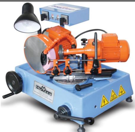
Стенд для восстановления геометрии клапана. Отличительной чертой является V-образный зажим штока клапана. Такой тип крепления более универсален и практичен чем цанга или трехкулачковый патрон. Стенд позволяет шлифовать торец штока и седло клапана. Станина изготовлена из чугуна. Подача смазочно-охлаждающей жидкости центробежным насосом.
