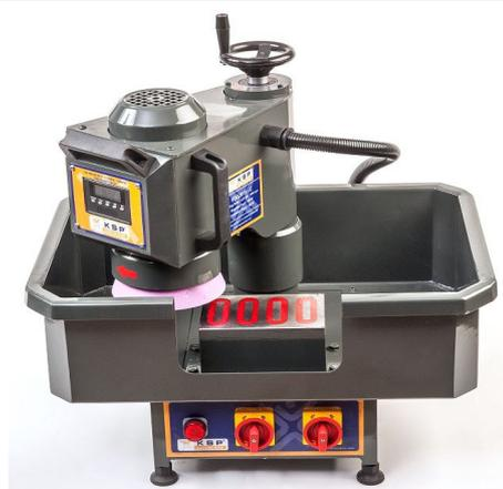
Настольный плоскошлифовальный станок VDG2015 - C. Основное его предназначение - это шлифовка мелкогабаритных деталей по типу регулировочных шайб с точностью до 0,01 мм. Станок оборудован цифровой индикацией. Детали крепятся на магнитном столе размером 150x100 мм. Подача смазочно-охлаждающей жидкости центробежным насосом.
