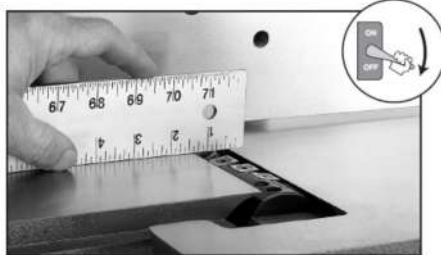
Рис. 63 Настройка высоты приемного стола
