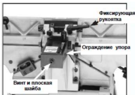
Рис. 12 Ограждение упора установлено
