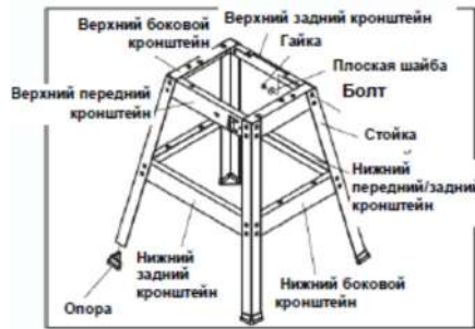
Рис. 3 Сборка станда
