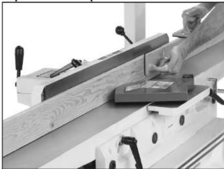
Рис. 27 Типичное фугование кромок
