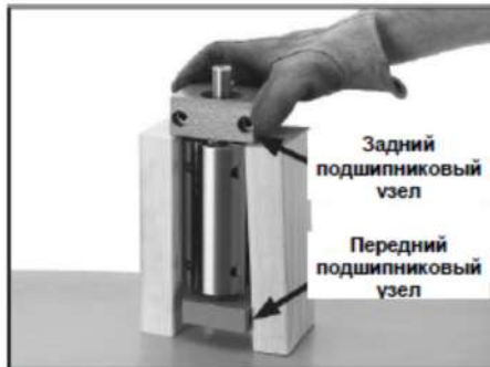
Рис. 57 Снятие заднего подшипникового узла
