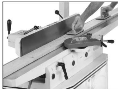
Рис. 25 Типичное строгание поверхности
