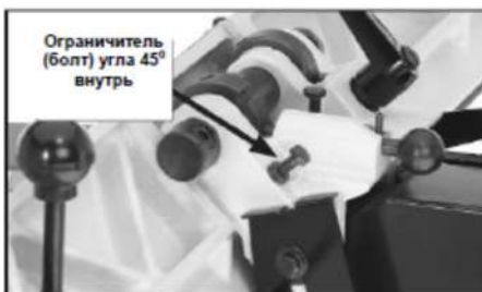
Рис. 44 Ограничитель упора для работы под углом 45° внутрь
