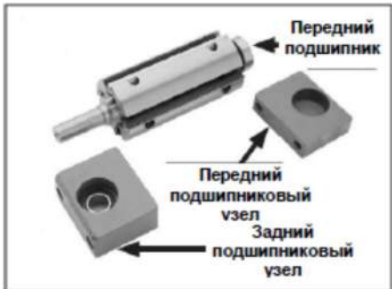
Рис. 58 Разобранный ножевой вал
