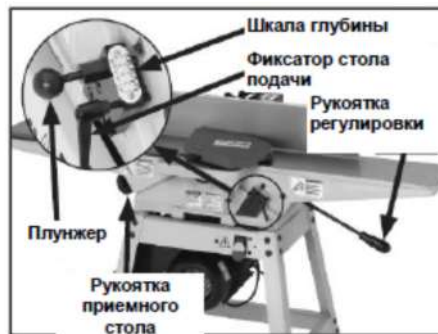
Рис. 18 Расположение элементов настройки стола
