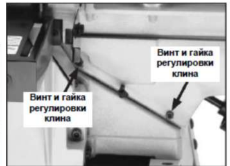
Рис. 47 Винты и контргайки клиньев стола
