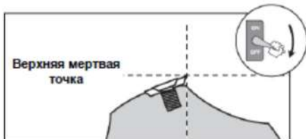
Рис. 62 Режущая пластина в ВМТ
