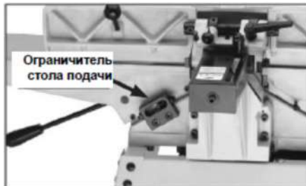
Рис. 19 Жесткие ограничители стола подачи
