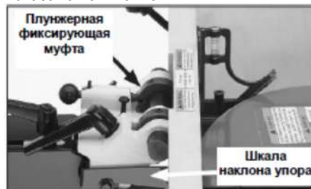
Рис. 45 Установка упора в положение 90°
