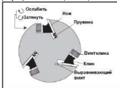
Рис. 38 Ножевой вал в разрезе
