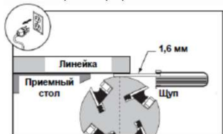
Рис. 36 Использование щупа для установки высоты приемного стола Затем отрегулируйте высоту ножей в соответствии с новой высотой приемного стола.
