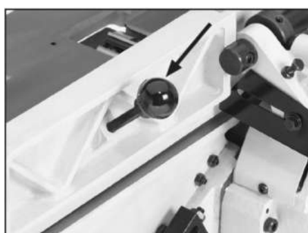
Рис. 13 Рукоятка регулировки установлена
