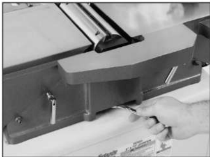
Рис. 55 Снятие гайки и стопорной шайбы
