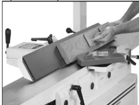
Рис. 29 Типичное стругание под углом
