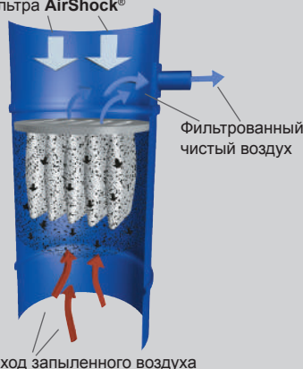
Система пневматической регенерации фильтра AirShock®
