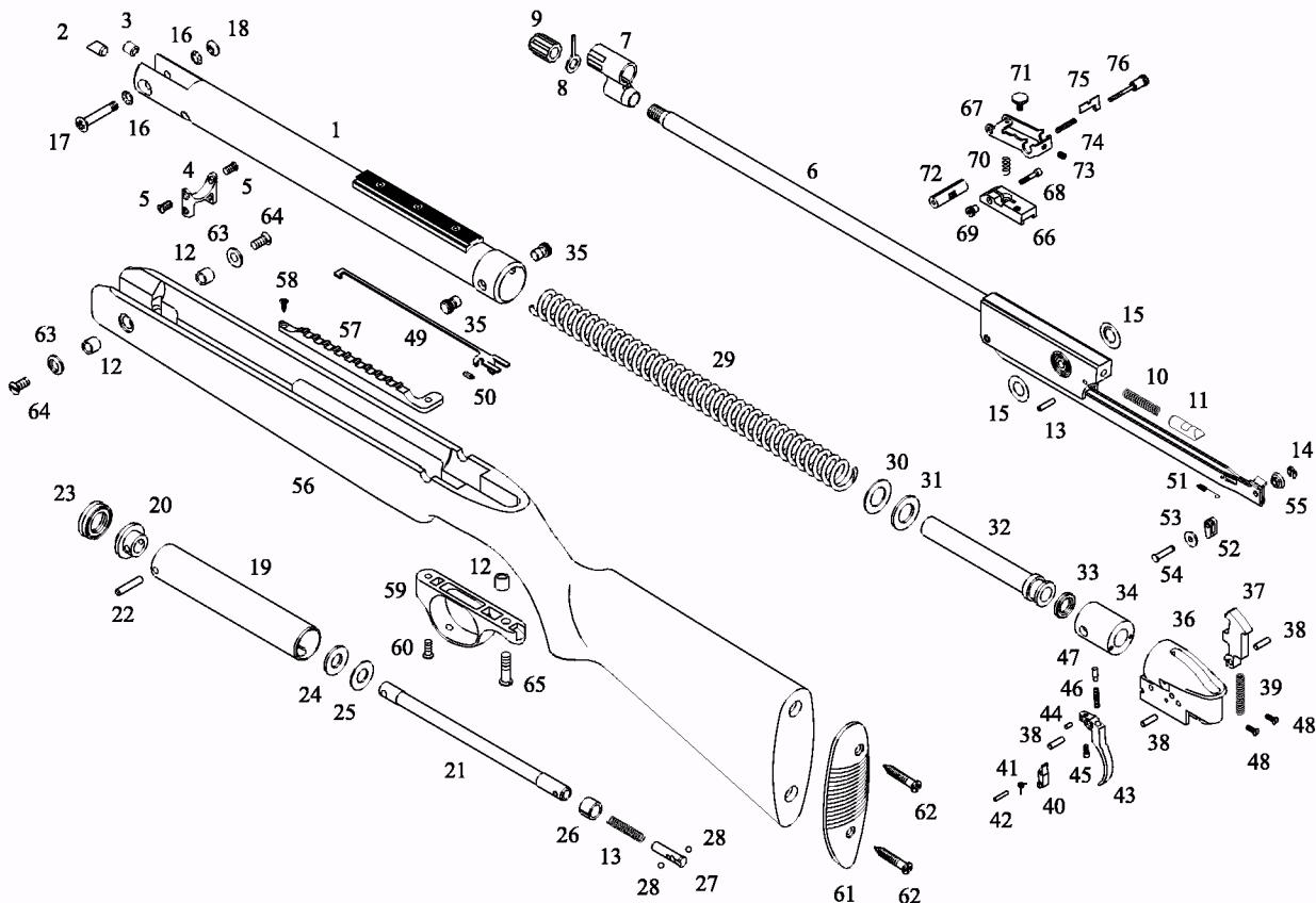
Рисунок А.2 – Сборочные единицы и детали винтовки
