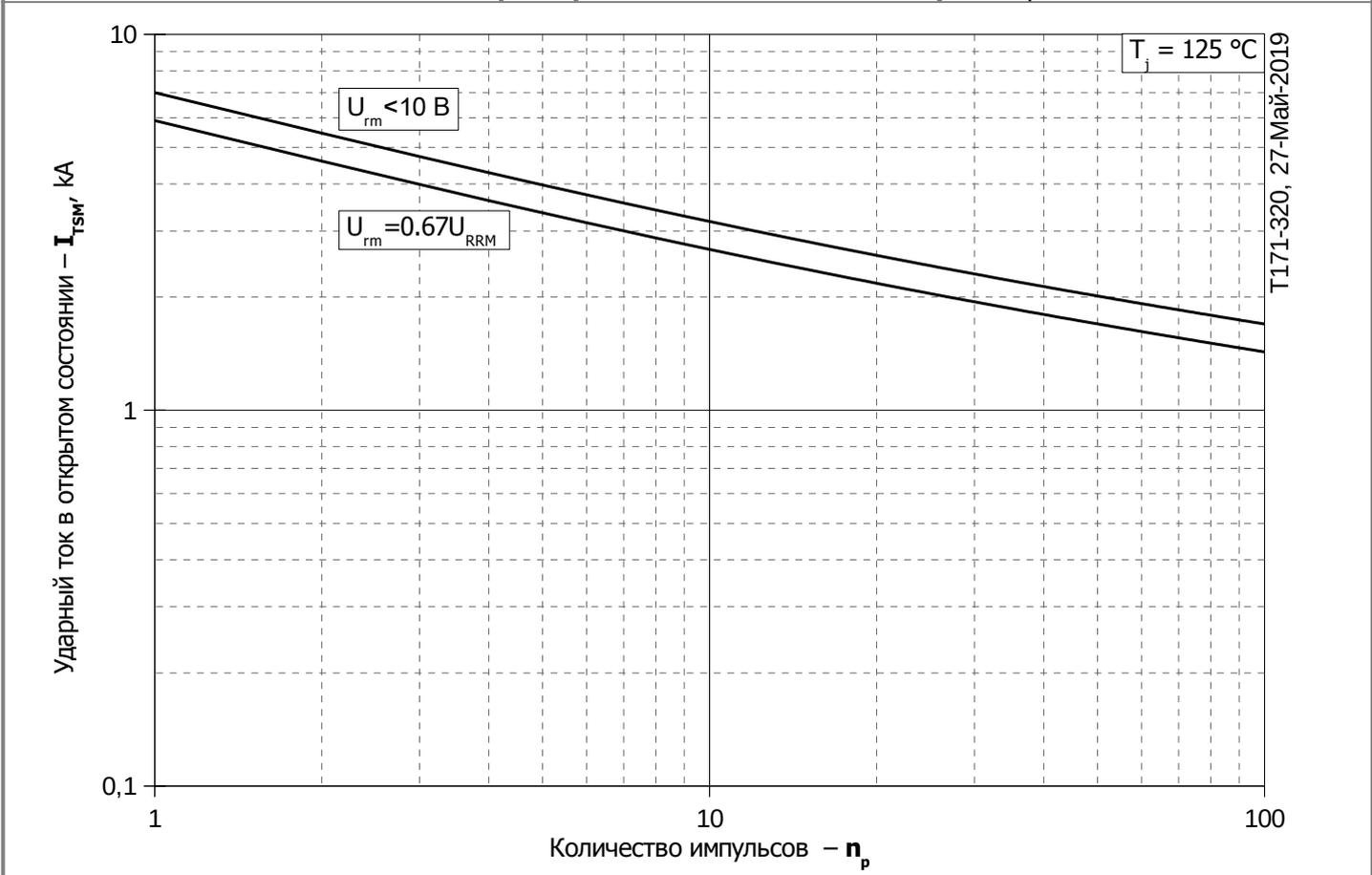
**Рис. 12 – Зависимость максимальной амплитуды ударного тока в открытом состоянии I<sub>TSM</sub> от количества импульсов n<sub>p</sub>**
