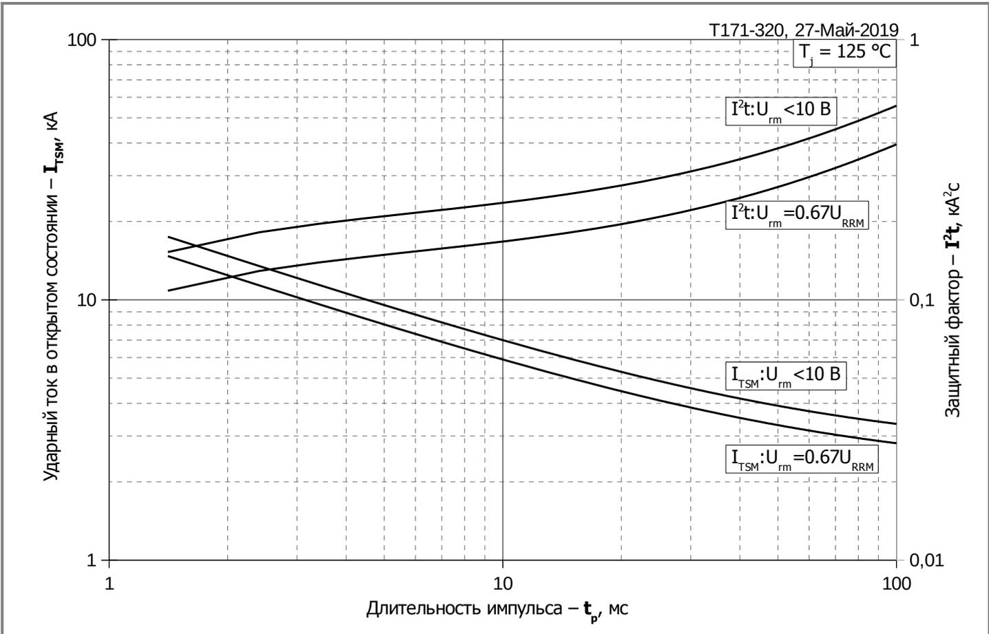
**Рис. 11 – Зависимость максимальной амплитуды ударного тока в открытом состоянии I<sub>TSM</sub> и защитного фактора I<sup>2</sup>t от длительности импульса t<sub>p</sub>**
