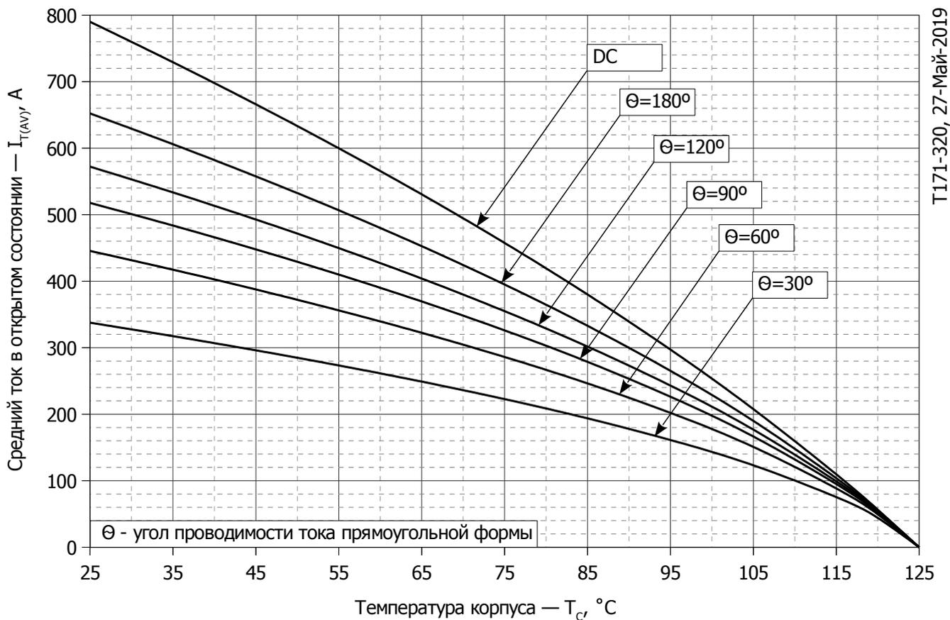
**Рис. 10 - Зависимость среднего тока в открытом состоянии  $I_{TAV}$  от температуры корпуса  $T_c$  для прямоугольной формы тока при различных углах проводимости ( $f=50$  Гц, Двустороннее охлаждение)**
