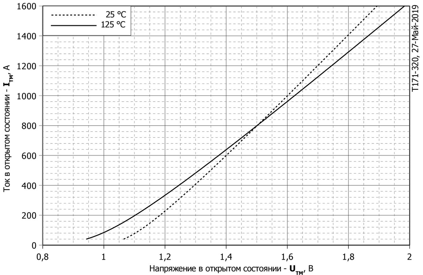
**Рис. 1 – Предельная вольт – амперная характеристика**
