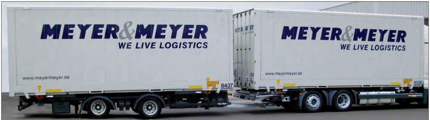
Der **DAUTEL SLIDER DS 1500/2000VT XXL** (zum Patent angemeldet) mit Integralheckeinheit ist bei einer LKW-Fahrhöhe von ca. 860 mm (Oberkante LKW-Rahmen) bei einer Abstellhöhe von 970 mm in Verbindung mit einer Tiefkupplung einsetzbar. Damit ergeben sich für den Logistikprofi vollkommen neue Einsatzmöglichkeiten im Bereich BDF-Volumentransporte.
