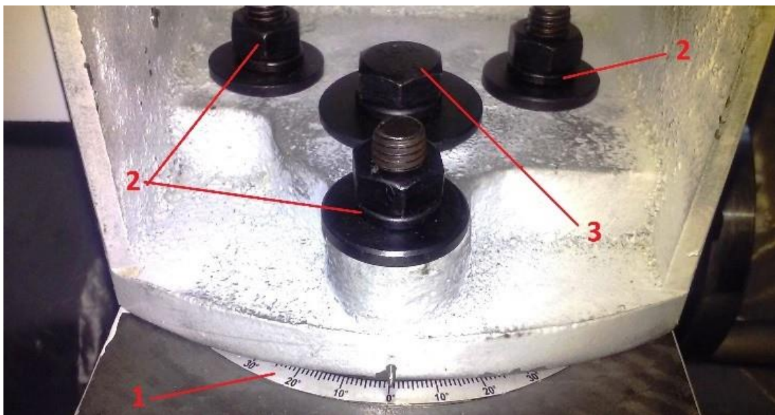
Мал. 1.4 Принципова будова верстата 1 – масштабна лінійка нахилу фрезерної голови; 2 – болти фіксування шпindelьної голови в нерухливому стані; 3 – болт вісі повороту шпindelьної голови
