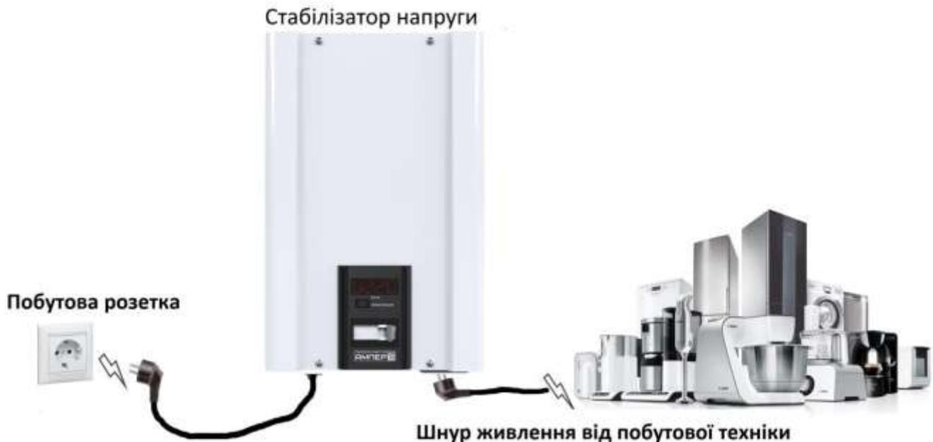
Рисунок 6. Підключення стабілізатора до мережі
