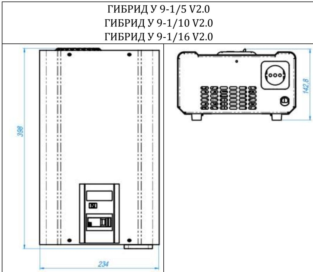
Рисунок 5. Габаритные размеры стабилизаторов
