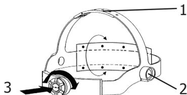
Маска FLIP-FLAP оснащена обручем который сварщик может подогнать по 4 параметрам: ширина, высота (1), наклон (2) и продольная посадка (3).
