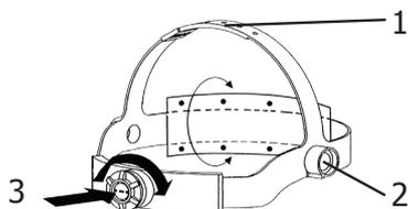
Le masque FLIP-FLAP est équipé d'un serre-tête qui offre 4 réglages au soudeur : largeur , hauteur (1), inclinaison (2) et ajustement longitudinal (3)
