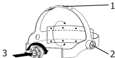
La máscara FLIP-FLAP tiene una diadema de ajuste con 4 ajustes: anchura, altura (1), inclinación (2) y ajuste longitudinal (3).
