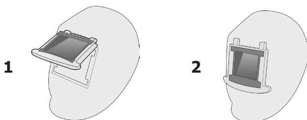
Máscara FLIP-FLAP está equipado con una diadema que ofrece el soldador 4 ajustes: anchura, altura (1), inclinación (2) y ajuste longitudinal (3)
