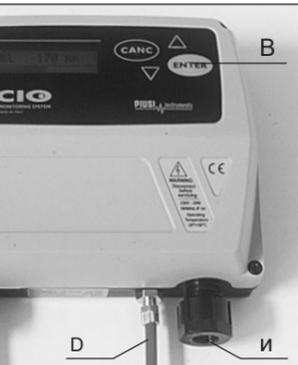
• A SONDA é introduzida no tanque e ligada à unidade de controlo tipo/ tipo
