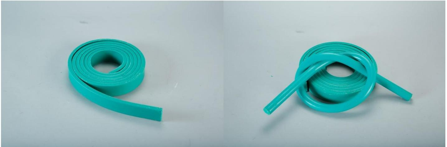
Герметизирующий профиль на основе гидрофильного полиуретана. В присутствии воды набухает и надежно герметизирует швы и стыки в конструкциях.
