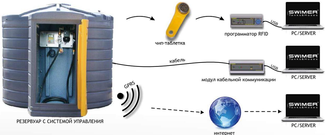
РЕЗЕРВУАР С СИСТЕМОЙ УПРАВЛЕНИЯ
