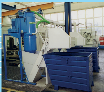
Стационарный вакуумный агрегат, уборка производственного оборудования
