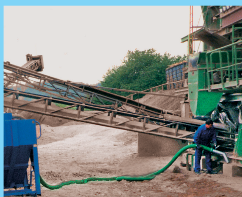
Очистка ленточного транспортера
