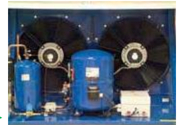
Блок охолодження нижнього випарника. Можливі також 2 охолоджувальні блоки
