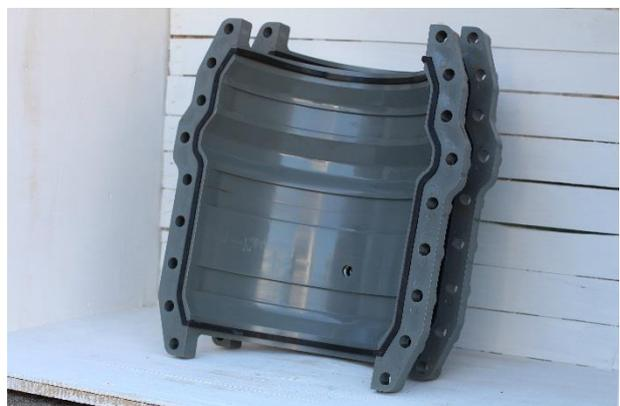
Углубление в корпусе хомута служит для ремонта раструба. Резьбовое отверстие с заглушкой, предназначено для установки хомута на аварийном участке трубопровода под давлением.
