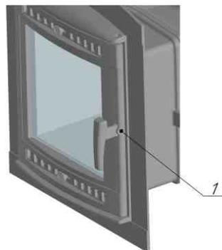
1. Прикрутить ручку винтом поз.1, с заранее установленными втулками, шайбами
