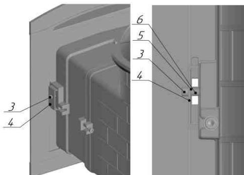
1. Прикрутить пластину поз.4 винтом поз.3, с заранее установленными втулками
