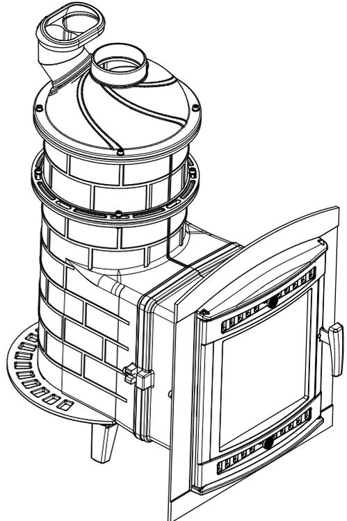
Диаметр дымохода **130 мм** (внешний) / **115 мм** (внутренний)
