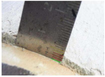
После нанесения 3 мм покрытия из композиции полимерминеральной «Керамоизол»была проведена промежуточная проверка лабораторией технической диагностики и неразрушающего контроля оборудования цеха № 59 ЧАО «ЛИНИК».
