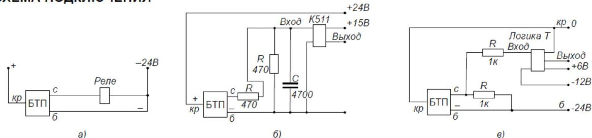
а – к электромагнитному реле; б – к логическим элементам серии 511; в – к логическим элементам «Логика Т»; цвета подключающих проводов: кр – красный (оранжевый), с – синий (голубой, зеленый), б – белый.
