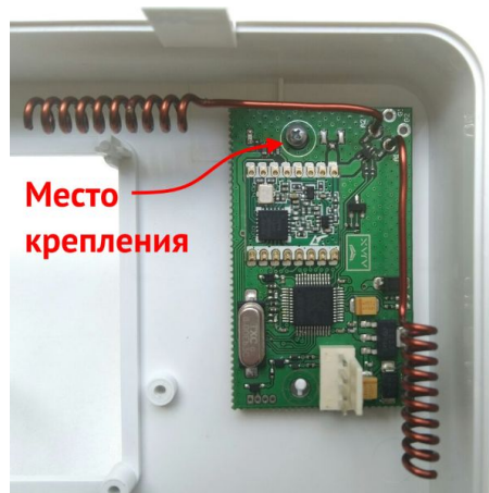
Рисунок 24. Радиоприемник Ажах «uartBridge» в корпусе ППКОП
