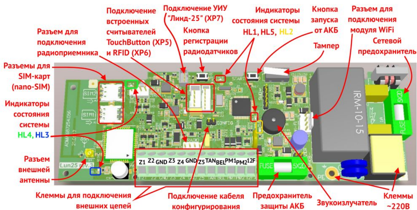
Рисунок 4. Расположение элементов на плате ППКОП
