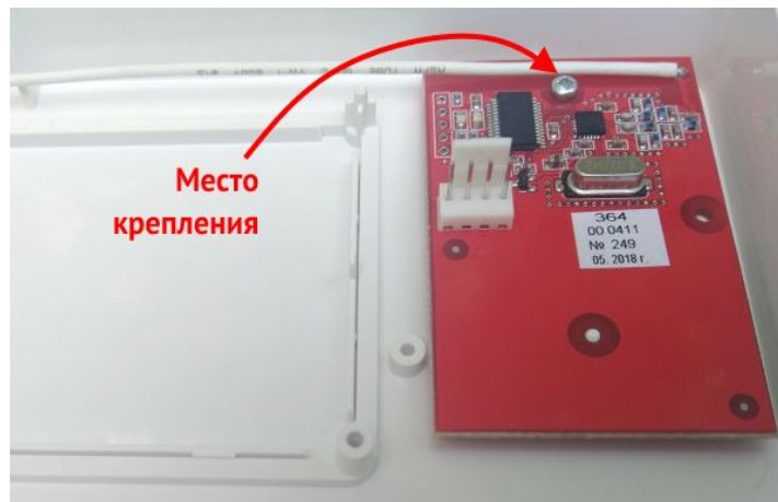
Рисунок 23. Радиоприемник «Lun RK1 v3» в корпусе ППКОП
