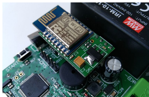
Рисунок 26. Установка WiFi модуля
