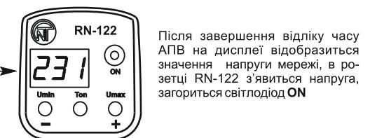
Після завершення відліку часу АПВ на дисплеї відобразиться значення напруги мережі, в розетці RN-122 з'явиться напруга, загориться світлодіод ON
