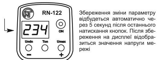
Збереження зміни параметру відбудеться автоматично через 5 секунд після останнього натискання кнопок. Після збереження на дисплеї відобразиться значення напруги мережі
