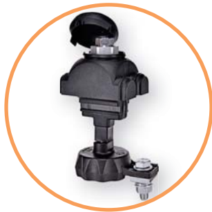
→ Зажим тип "FK" с проколом изоляции с двух сторон, оснащённый болтом со срывной головкой и возможностью установки под напряжением, 10 - 95 mm 2
