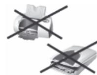
**ВНИМАНИЕ: НИКОГДА** не подсоединяйте лазерный принтер или сканер к устройству ИБП. Это может привести к повреждению устройства
