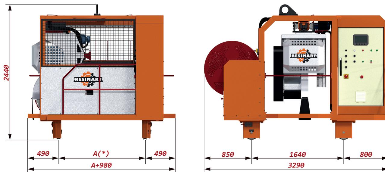
Габариты машины с максимальной высотой резки до 300мм и с диском Ø900мм
