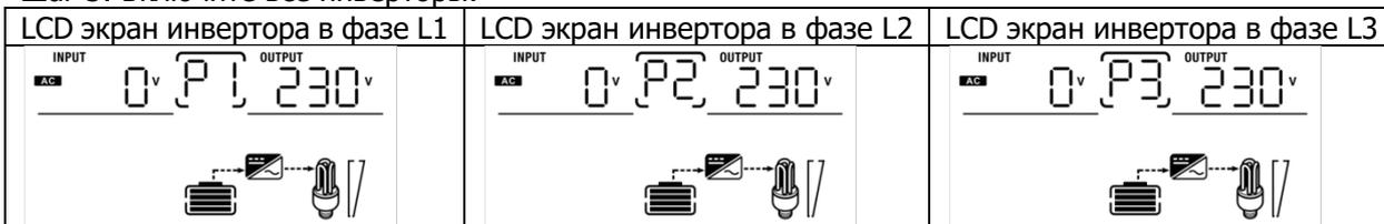
Шаг 4: Включите все автоматы переменного тока на входе переменного тока. Если обнаружено подключение переменного тока и три фазы соответствуют настройке устройства, они будут работать нормально. В противном случае значок AC будет мигать, и они не будут работать в сетевом режиме.
