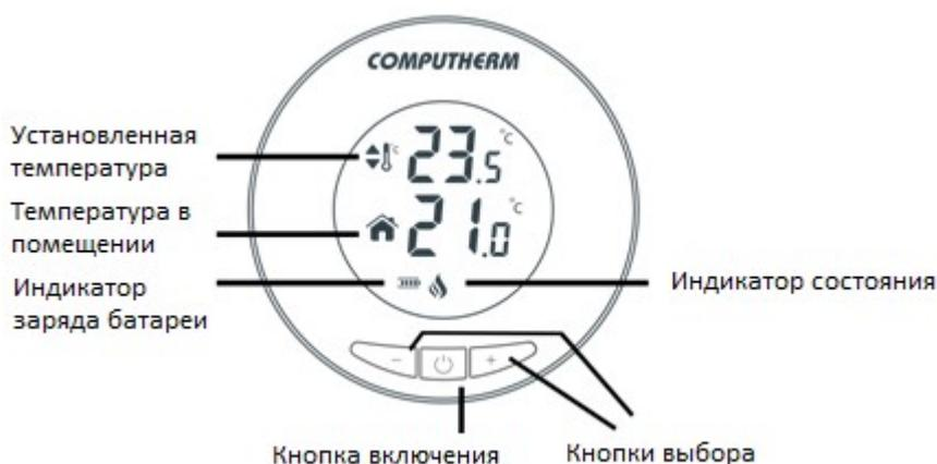
Устройство состоит из двух блоков. Один - переносной блок управления (термостат), другой - приемный блок, управляющий котлом. Между двумя блоками существует беспроводная (радиочастотная) связь, поэтому нет необходимости прокладывать провод между термостатом и котлом.
