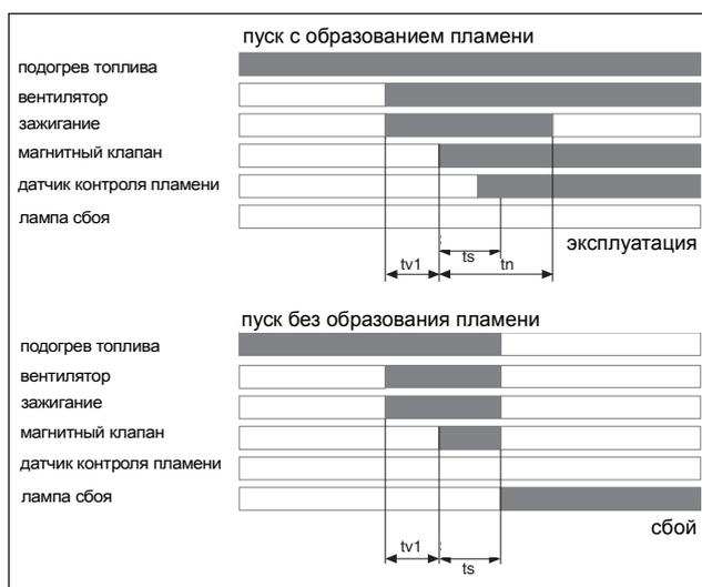
ts - контрольно-предохранительный период
