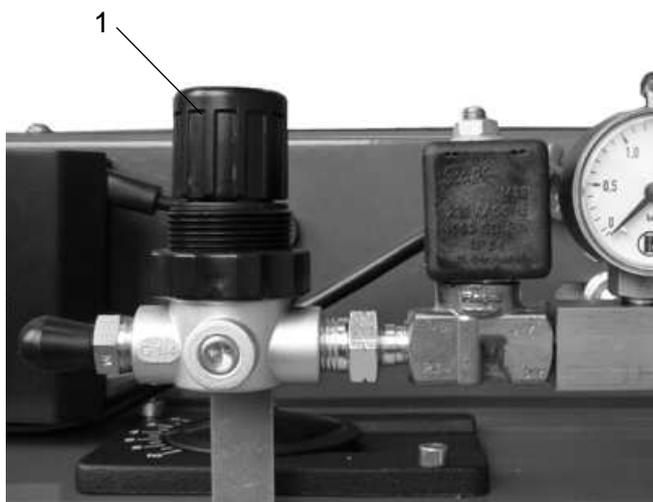
Первичный воздух устанавливается в зависимости от необходимой мощности регулятором давления воздуха (1). Необходимые данные можно определить по ниже приведённой диаграмме. Топливо с большей вязкостью требует более высокое давление воздуха.
