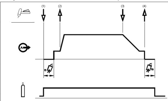
1. Нажмите и удерживайте курок TIG-горелки, чтобы запустить выполнение последовательности. При этом откроется газовый клапан и начнется подача защитного газа. После предварительной подачи газа для удаления воздуха из шланга горелки, аппарат начинает производить сварочный ток. В этот момент происходит возбуждение дуги в соответствии с выбранным режимом сварки. В режиме поджига дуги LIFT ток поджига
