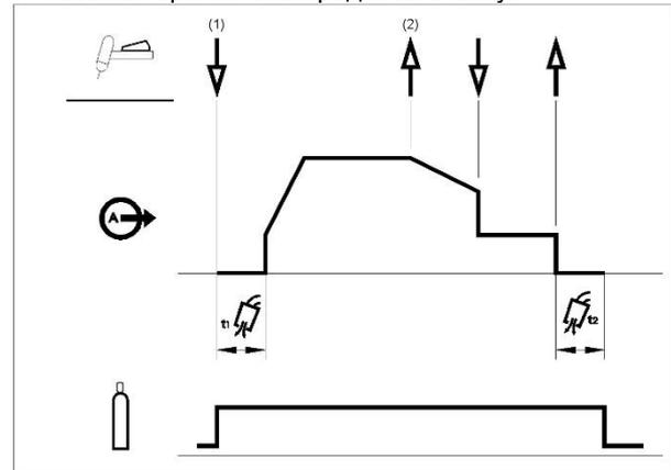
Как показано выше, можно нажать и удерживать курок TIG-горелки второй раз во время понижения тока, чтобы завершить функцию понижения и поддерживать ток сварки при токе кратера. При отпуске курка TIG-горелки происходит прекращение подачи сварочного тока и начинается заключительная подача защитного газа. Данная рабочая последовательность (2-шаговая без возможности повторного включения) является заводской установкой.
