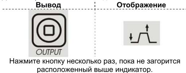
При активации 2-шаговой последовательности и включении режима TIG-сварки выполняется следующая последовательность сварки.
