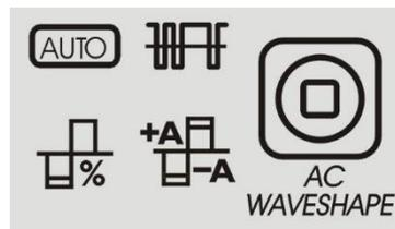
Эти значки позволяют оператору настраивать характеристики дуги для сварки TIG только для полярности AC (пер.ток).
