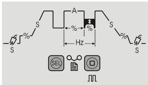
Программируемый контроллер позволяют оператору настраивать характеристики сварки TIG для обеих полярностей — AC (пер. ток) и DC (пост. ток).
