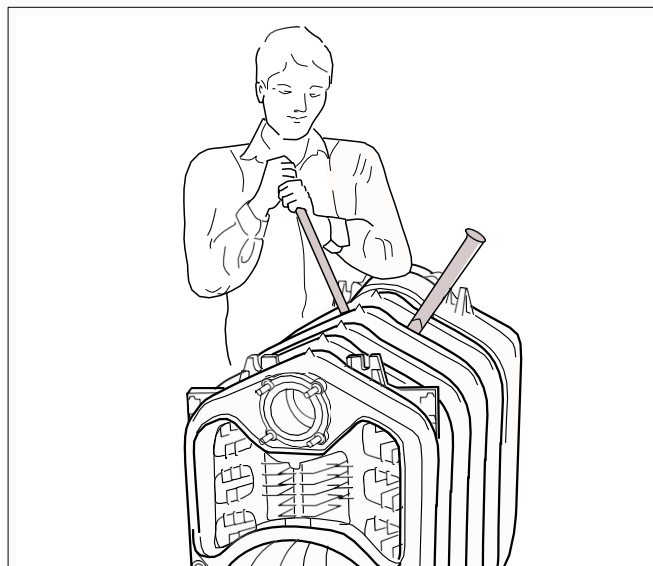
Рис. 27 Разъединение секций котла
