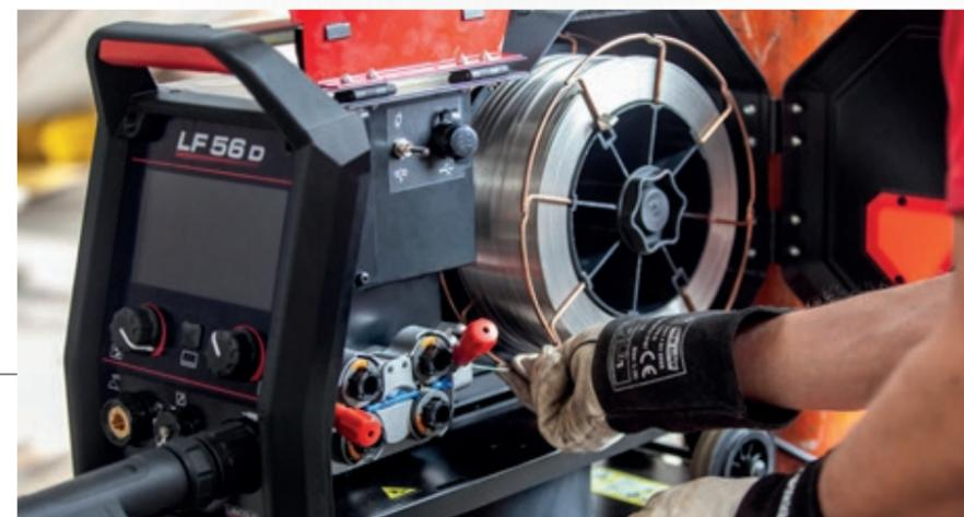
Полный доступ для установки катушки. Отличная проходимость, 4 ролика и внутренняя подсветка.
