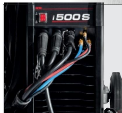
Подключение кабелей на передней (в стандартной комплектации) и задней панели (как опция). Компенсаторы натяжения с обеих сторон защищают разъемы.
