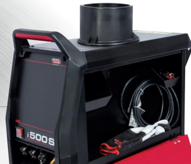
Большой практичный отсек для хранения внутри аппарата закрывается на ключ, для таких аксессуаров как горелки, перчатки, ролики, контактные наконечники и т.д.
