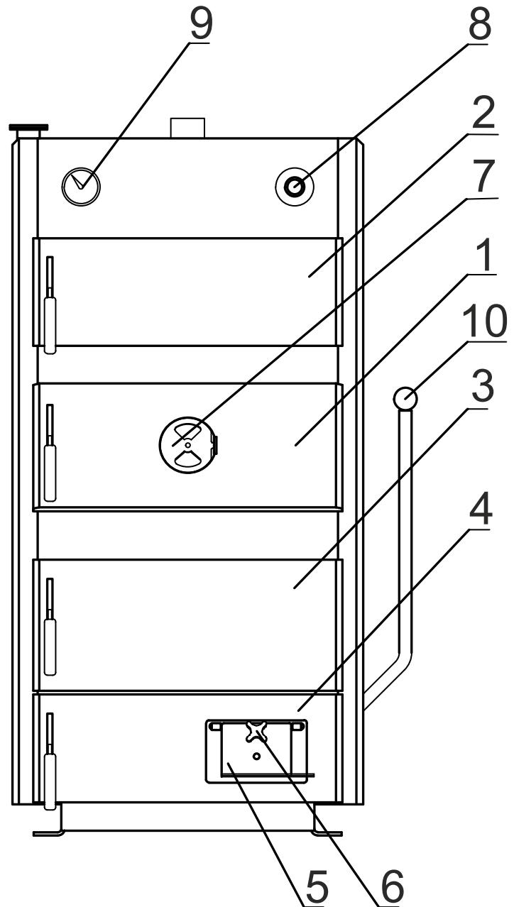
Рисунок 7.1 Основные элементы конструкции котла SE MAX II
