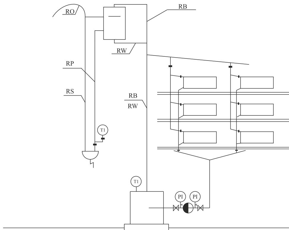
Рисунок 8.2.1 Схема подключения котла к отопительной системе
