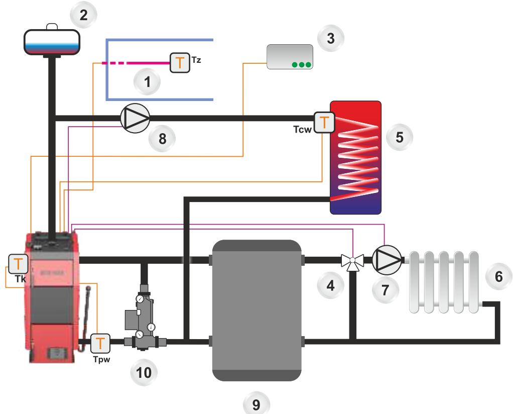
Рисунок 8.2.4 Подключение котла к отопительной системе слайдоматом и буфером
