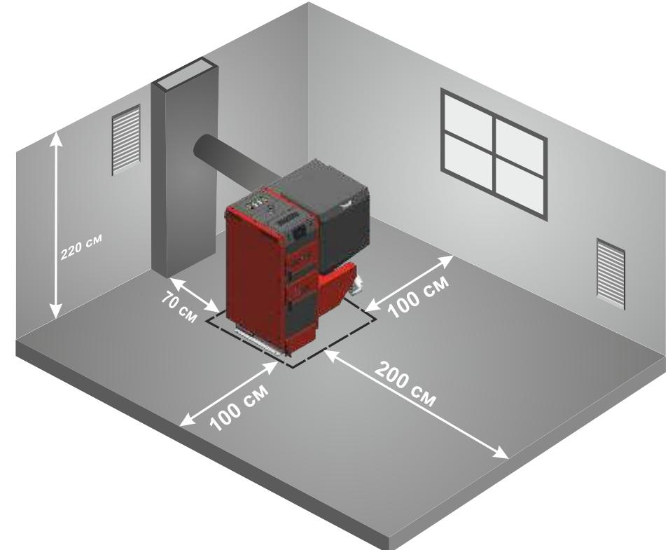
Рисунок 8.1 Минимальные расстояния при установке котла в котельной
