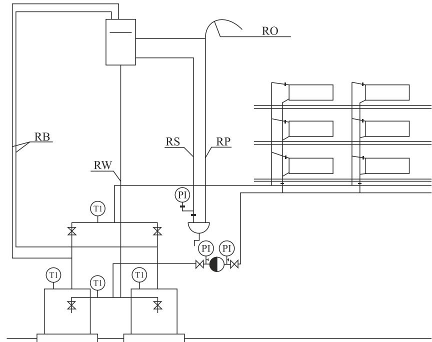
Рисунок 8.2.2 Схема подключения котлов к отопительной системе
