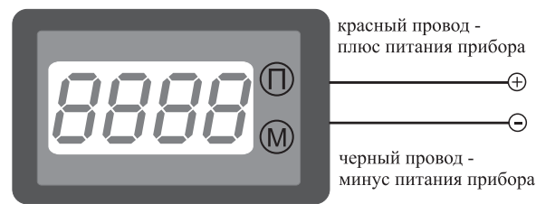
Рис.1. Подключение прибора. Допустимо питание только постоянным током.
