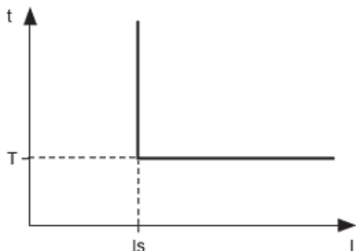
Рисунок 1.4 - Принцип защиты с независимой выдержкой времени
