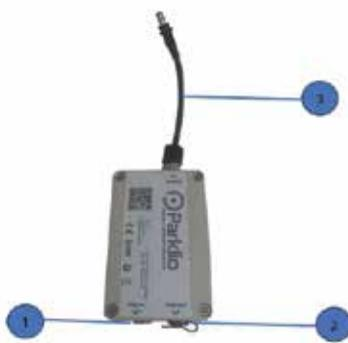
Рисунок 6 - Батарейный отсек
