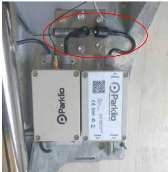
Slika 13 - Priključak za napajanje
