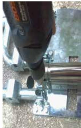
Рисунок 9 - Сверление отмеченных мест
