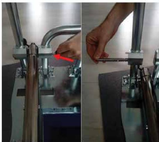
Рисунок 34 - Удаление предохранительного штифта
