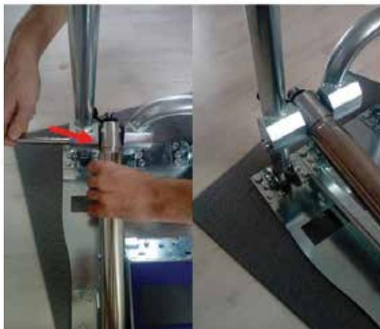
Рисунок 33 - Установка английской булавки
