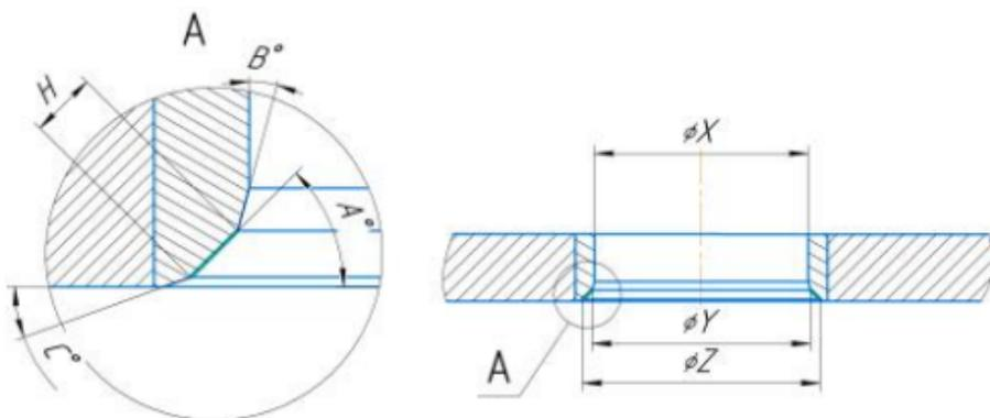
$A^\circ$  – угол рабочей фаски седла клапана;
