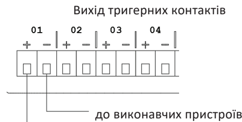
3.5. Схема підключення зовнішніх виконавчих пристроїв
